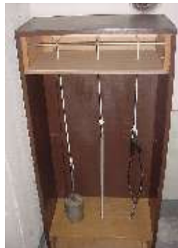
Slika 10: Elastične deformacije elastik zaradi različnih uteži
