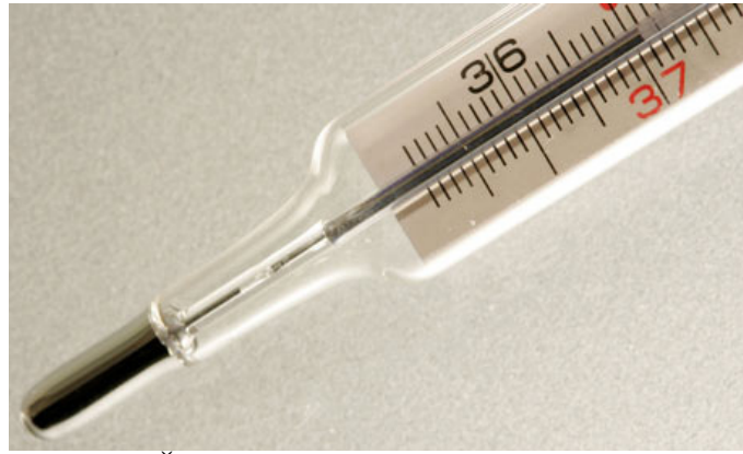
Slika 47: Živosrebrni termometer z zoženo kapilarno
