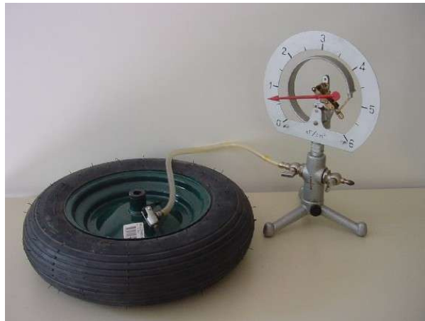
Slika 41: Manometer na Bourdonovo cev za merjenje tlaka v pnevmatiki
