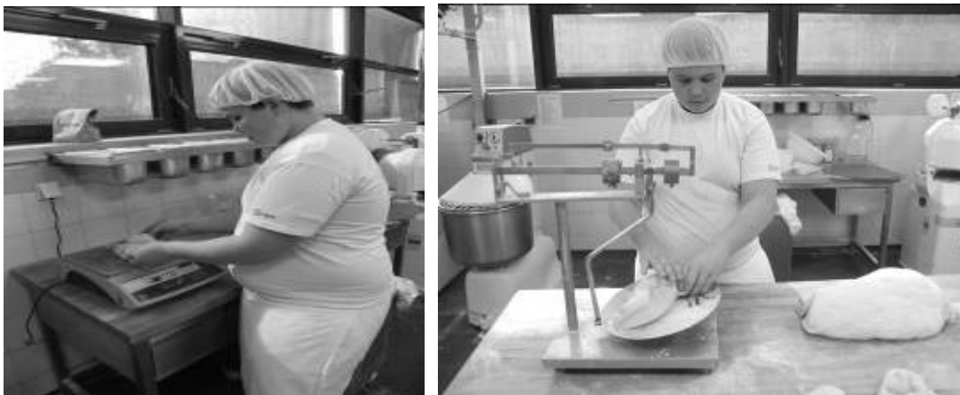
Slika 23: Določanje teže z avtomatsko tehtnico in določanje teže testenih kosov z ročno, pekovsko tehtnico (Vir: Učna prodajalna IC PIRAMIDA MARIBOR – I.Rihter)
