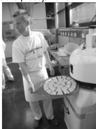
Slika 24: Avtomatsko deljenje manjših testenih kosov (Vir: Učna prodajalna IC PIRAMIDA MARIBOR – I.Rihter)
