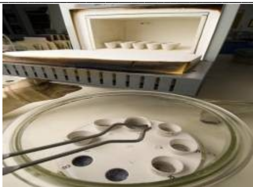
Slika16: Žarilna peč v kateri izvedemo popolni sežig vzorca
