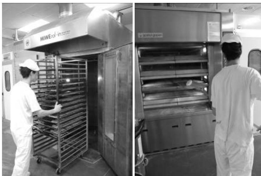
Slika 30: Uporaba rotacijske in etažne peči za pečenje (Vir: Učna prodajalna IC PIRAMIDA MARIBOR – I.Rihter)
