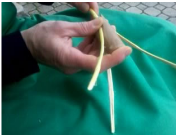
Slika 11: Potiskanje razcepnika (Vir: H. Košmerlj )
