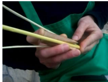
Slika 11: Potiskanje razcepnika (Vir: H. Košmerlj )
