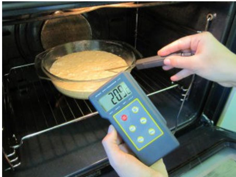
**Slika 69: Merjenje središčne temperature jedi med toplotno obdelavo – ena izmed metod izvajanja notranjega nadzora**
