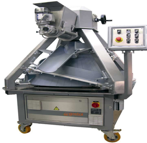
Slika 18: Stožčasti stroj za okroglanje SABOTIN (Vir: www.gostol-tst.si )
