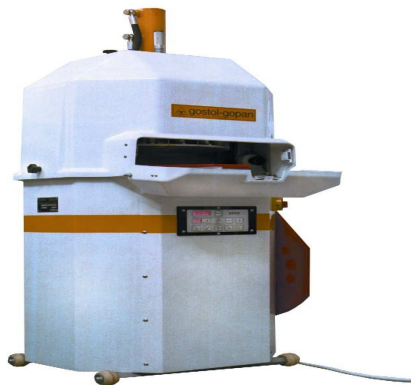
Slika 23: Delilno – oblikovalni stroj DOPAS in ADOS (Vir: www.gostol-tst.si )
