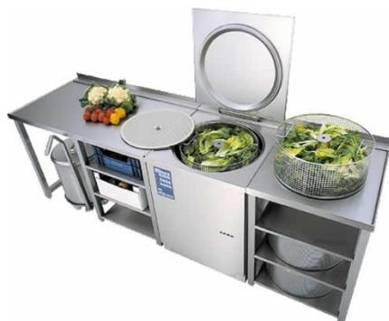
Slika 48: Šaržni stroj za pranje solate (Spec-Net, 2012)
