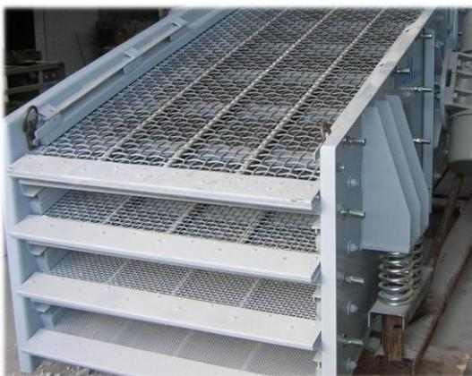
Slika 59: Vibracijska sejalna naprava
