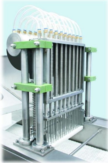
Slika 36: Več igelni stroj za vbrizgavanje razsolice (Hebei Yuanchang Food Mechanism & Technology Co., 2010)
