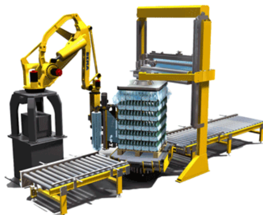
Slika 184: Robotizirano ovijanje palet (Electric 80, 2010)
