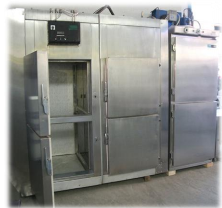
Slika 105: Zamrzovalna komora za šok zamrzovanje
