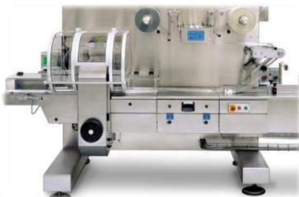
Slika 176: Stroj za pakiranje v modificirani atmosferi – izdelava embalaže v obliki vrečk
