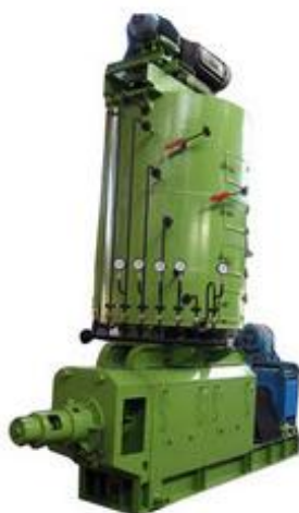
Slika 173: Dvoetažna naprava za kondicioniranje oljnih semen (Kumar Metal Industries, 2010)
