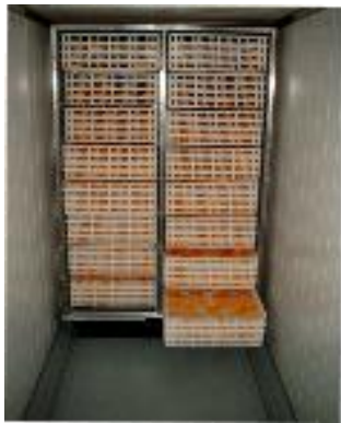
Slika 145: Sušilni tunnel, v njem so vozički s sadjem (Heatec, 2010)
