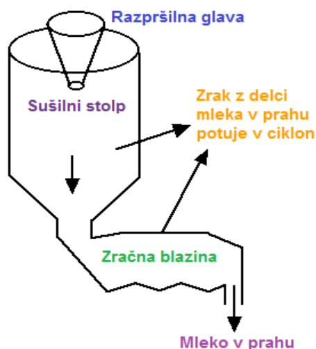
Slika 67: Shema dvostopenjskega razpršilnega sušilnika (Goff, D., 2010)
