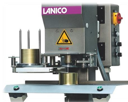
Slika 178: Stroj za zapiranje konzerv z zapogibanjem
