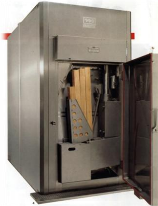
Slika 40: Prekajevalna komora s frikcijskim generatorjem
