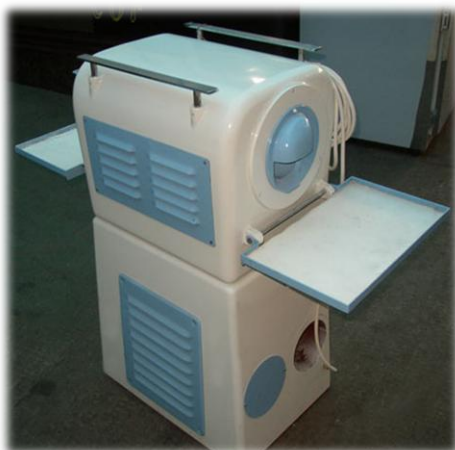
Slika 98: Tunelski stroj za okrogljenje testa
