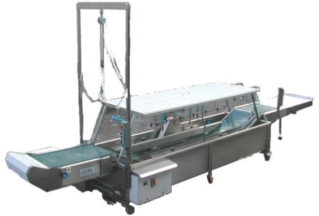
Slika 125: Stroj za pranje zelenjave v zabojčkih
