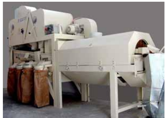
Slika 78: Izdvajalec težkih primesi
