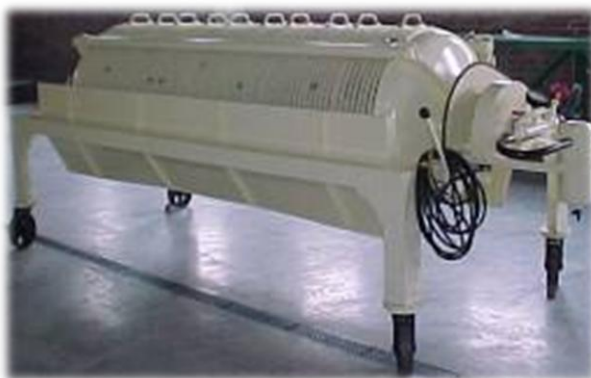
Slika 155: Horizontalna (vodoravna) hidravlična stiskalnica (Barr, H., 2010)
