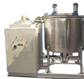
Slika 50: Hladilni bazen z direktno evaporacijo hladilnega sredstva
