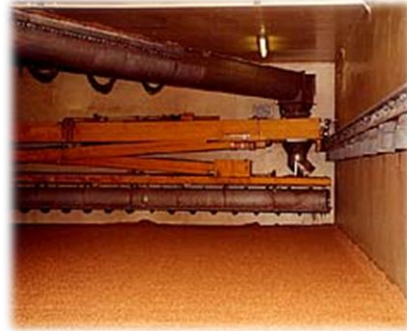
Slika 161: Etažni sušilnik za sušenje sladu (Bamberger Mälzerei, 2010)
