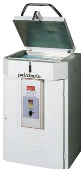
Slika 94: Hidravlični delilni stroj za manjše kose testa
