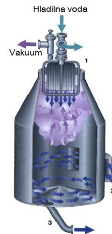
Slika 65: Shema vakuumskega deaeratorja (Steffe, J. F., 2010)
